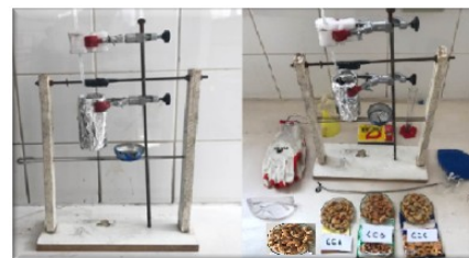
Figura 01: Aparato usado para a determinação do calor de combustão da castanha.
